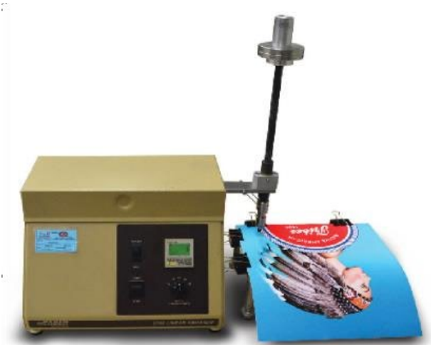
Рисунок 1. Испытания на царапины и истирание проводятся с помощью тестера Taber в соответствии со стандартными методами испытаний.
